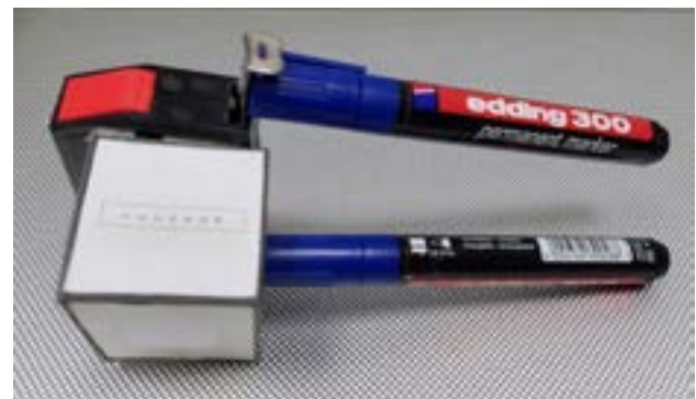
Рис. 2. Будова проксиметра: пластиковий куб, рулетка, маркери в якості рукояток.
