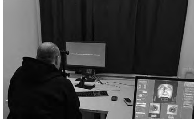
Рис. 1. Айтрекер EyeLink 1000 Plus (SR Research Ltd., Канада)
