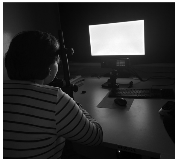
Рис. 3. Демонстрація положення учасника дослідження під час калібрування з використанням підборідника та лобового фіксатора.
